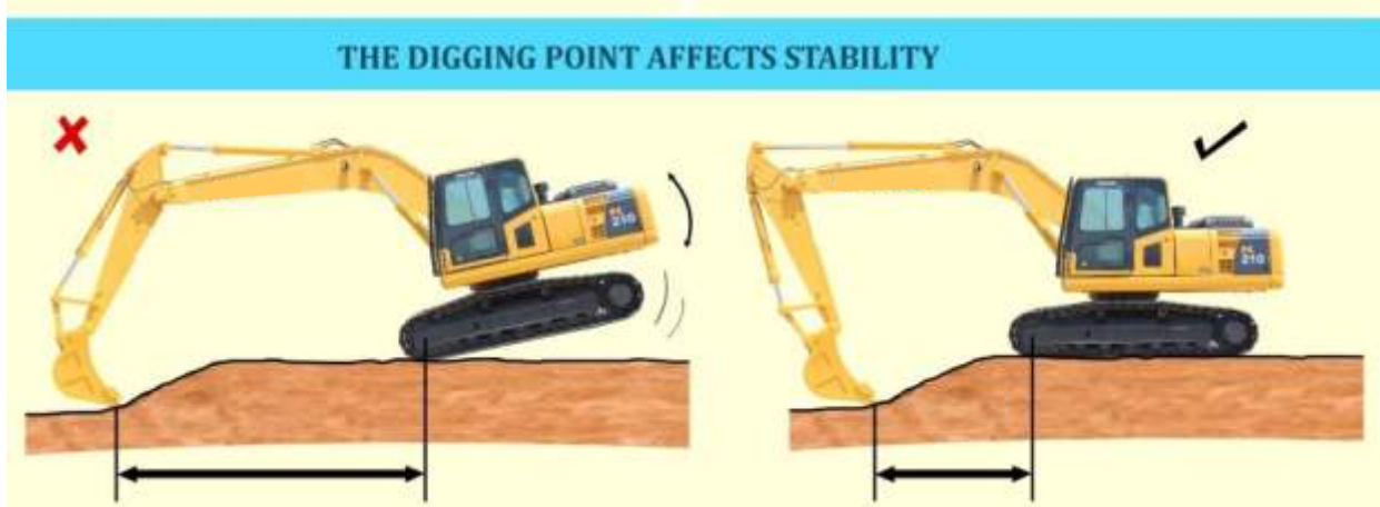
Fig 3.2.1 (d) Digging Point Distance
